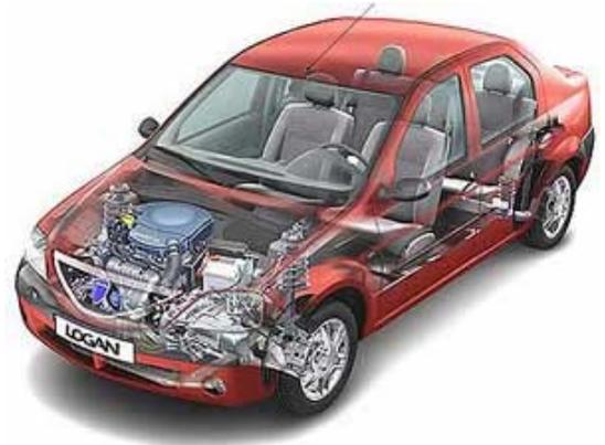
*Malgré les tarifs modérés de la Logan, son moteur Diesel bénéficie d'une technologie de pointe : le système d'injection directe de gazole par rampe commune. L'élément essentiel est l'injecteur qui pulvérise en quelques fractions de seconde une très faible quantité de gazole directement dans la chambre de combustion où se produit l'explosion du mélange air-gazole.*
