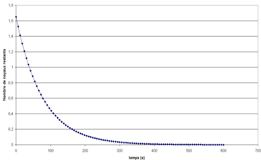
Comparaison entre les résultats expérimentaux de comptage et ceux obtenus par la méthode d'Euler.
